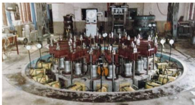
图 21 模拟双层钢板高强混凝土复合井壁
