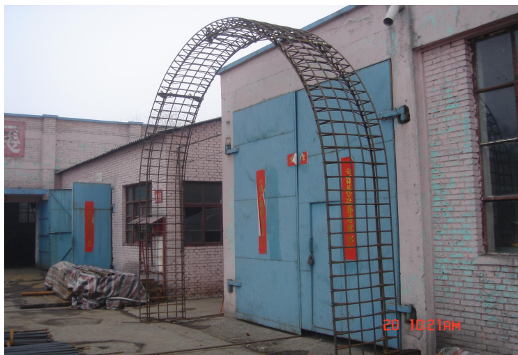
图 41 工厂加工的网壳支架
